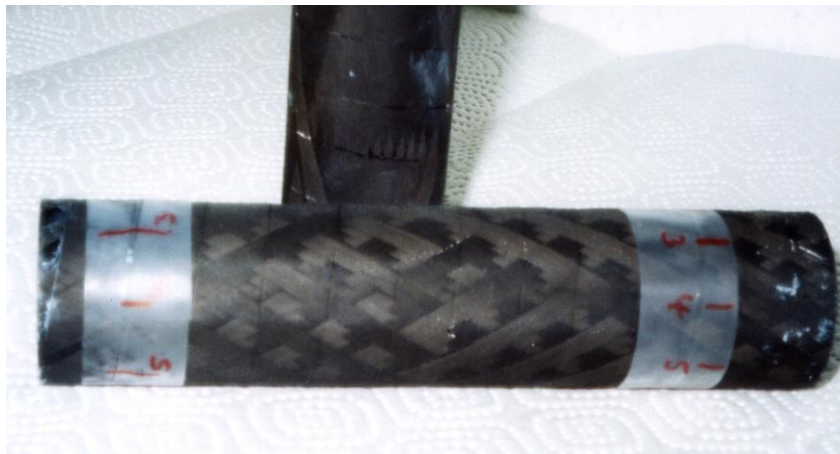
Bild 1 Gewickelte Zylinder aus hoch-wärmeleitfähigen Pechfasern ( d_i=32\text{mm} , d_a=35\text{mm} und l=150\text{mm} ) mit unterschiedlichen Wickelmustern ( [\pm 15] , [\pm 15, \pm 30] )
