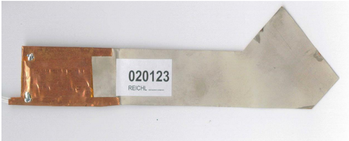
Bild 7: Flexibler Walzendruck Sensor mit 16 abgewinkelten Messflächen.
