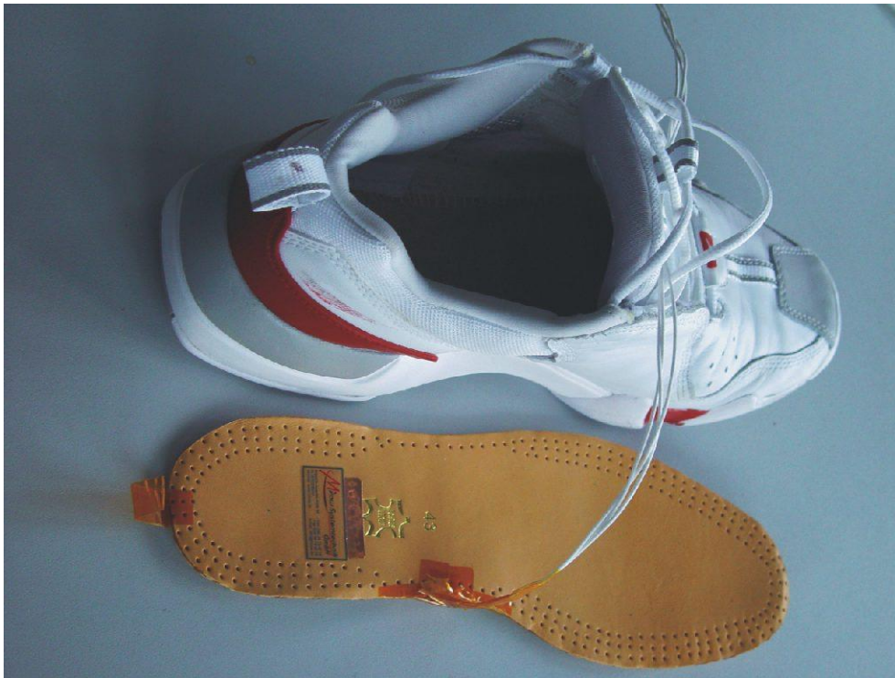
Bild 5: Fußsohlensensor mit integriertem Verstärkersystem als Einlegesohle präpariert.
