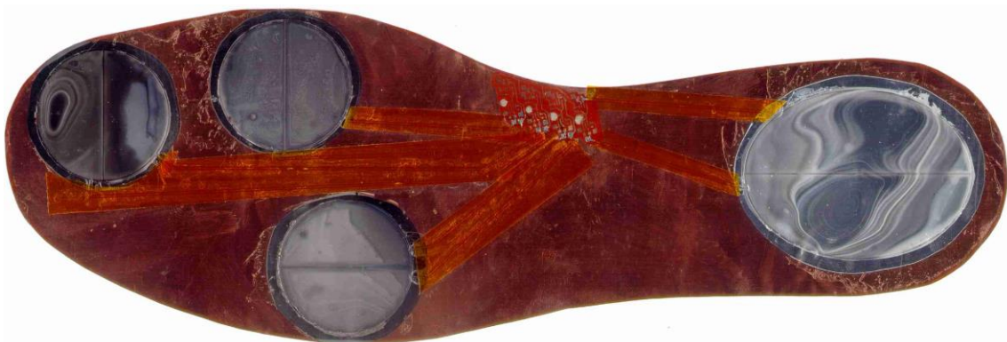
Bild 4: Rohbau des flexiblen Fußsohlensensors mit acht Doppel- Sensor- Bereichen.
