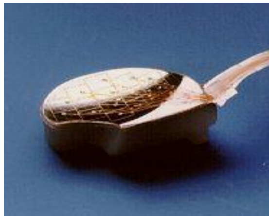
Bild 8: Künstlicher Meniskusknorpel mit 14 Sensoren auf der 3D gekrümmten Gleitfläche.
