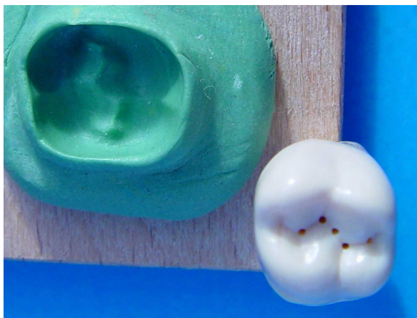
Bild 1: Präparierte Sensorbereiche in einer Zahn- Kaufäche mit Negativabdruck.
